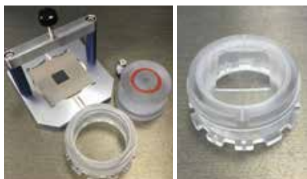
印章制造工具（左图）及制造好的柔性印章（右图）
