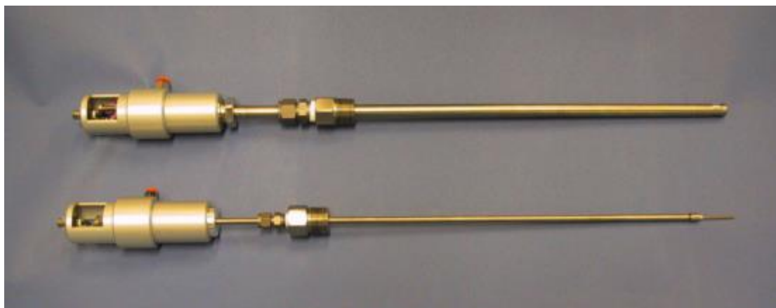
图3 高温高压参比电极与氧化还原电极（辅助电极）
