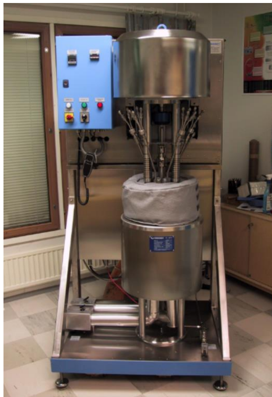
50kN 高温高压慢拉伸（600°C，35MPa）
