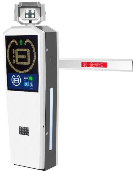
QQB7 小泊机器人，是配备 300 万像素高清车牌识别摄像机、智能补光系统、智能语音合成、7 色高亮 LED 显示屏以及快速平稳的直流无刷道闸的一种车道智能管理设备，具备 4G 无线通讯通信网络，方便快捷获取云端赋能，随着云端功能的持续更新，持续迭代，小泊机器人的功能也会跟随云端的提升而更加强大。无线遥控确认放行车辆，云端详细记录每次确认的通讯记录；小泊机器人能够判断车辆移动方向，具备倒车关闸、会车智能仲裁等精细化车道管理功能。小泊机器人不依赖本地管理电脑，从云端获取停车管理服务，能够独立管理车道，控制道闸开启和关闭，是一种精巧完美的停车场出入口车辆管理智能设备。
