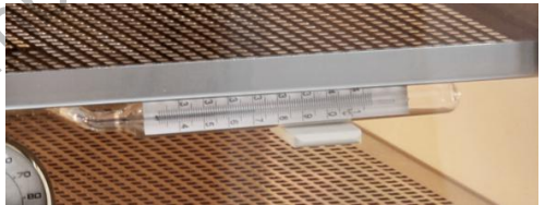
直角温度计放于托盘下方，刻度面朝外。
