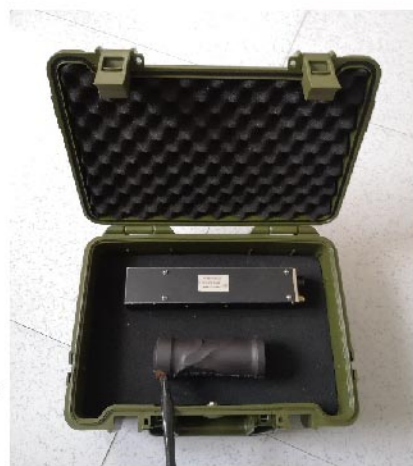
图1. 小型化铯光泵磁力仪CAS-OPM-SV
