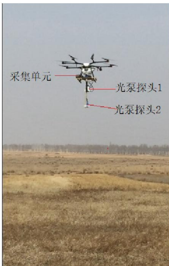
图3. 无人机航磁梯度测量系统
