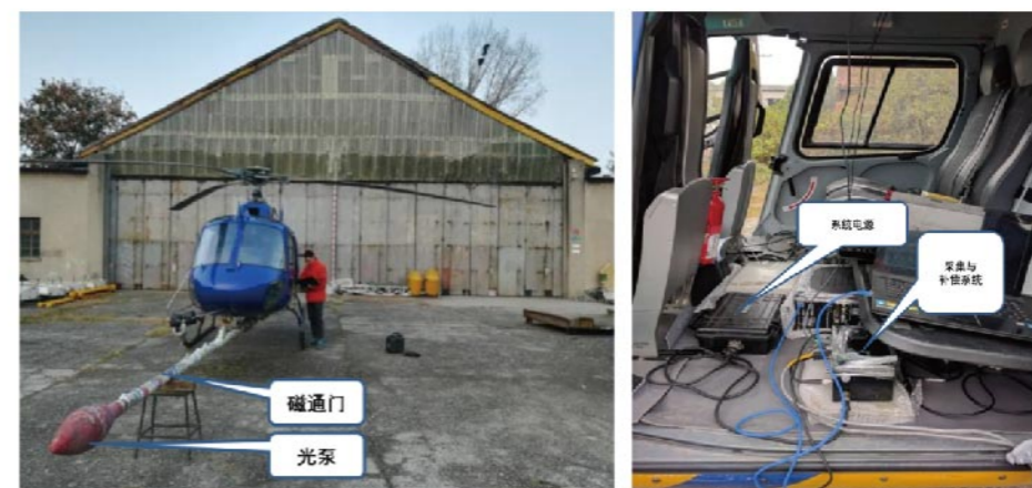
图5. 光泵磁传感器安装位置以及舱内系统示意图
